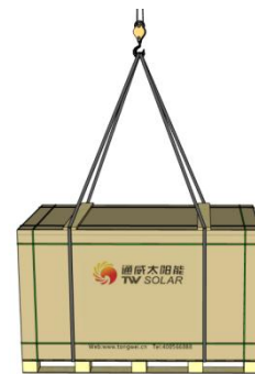
图 5 组件吊装示意图
